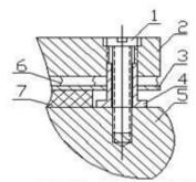
Схема электромагнитного тормоза
